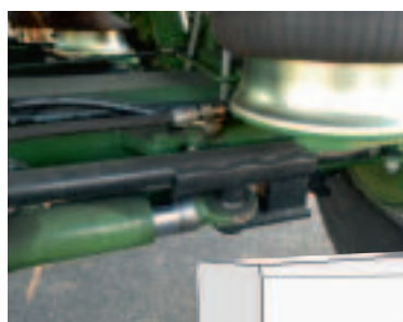
Mit Hydraulikzylindern werden die Räder in die richtige Stellung gebracht.
