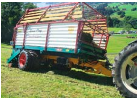
Die beiden Systeme mit gelenkter Triebachse: Steer-Drive-Trailer von Walter Roggenmoser, Unterägeri und...
