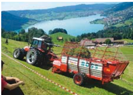
Ungelenkte Triebachse macht berggänglich. Doch können Kurvenfahrten gefährlich werden. (Bilder: Jules Furrer)
