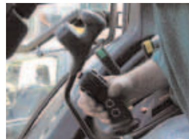
Abbildung 3: Multifunktionshebel zur Bedienung der Hubwerke und der Gangschaltung.
