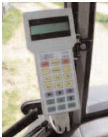
Abbildung 6: Terminal zur Einstellung und Abfrage der Funktionen.
