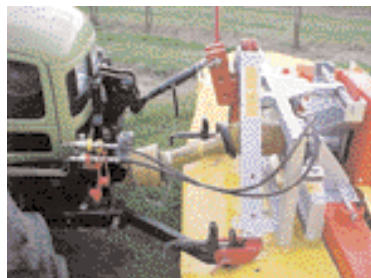
Abbildung 2: Mähwerkanbau mit Anbaudreieck und Seitenverschiebung.
