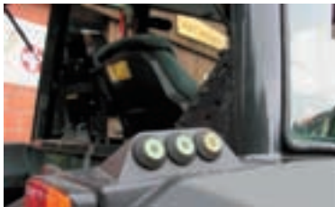
Die Funktionen im Heckbereich lassen sich auch extern bedienen.
