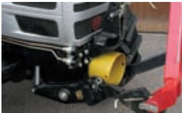
Die Fronthydraulik wird mit der Mähwerksentlastung genutzt.
