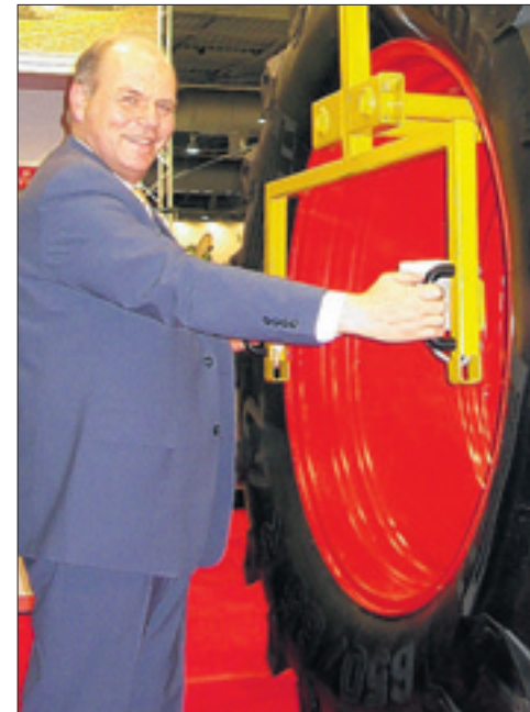
Mit dem «Twin Carrier» von Schaad lassen sich Doppelräder auch im Einmannbetrieb an großen Traktoren auf dem Feld ohne körperliche Kraftanwendung montieren.
