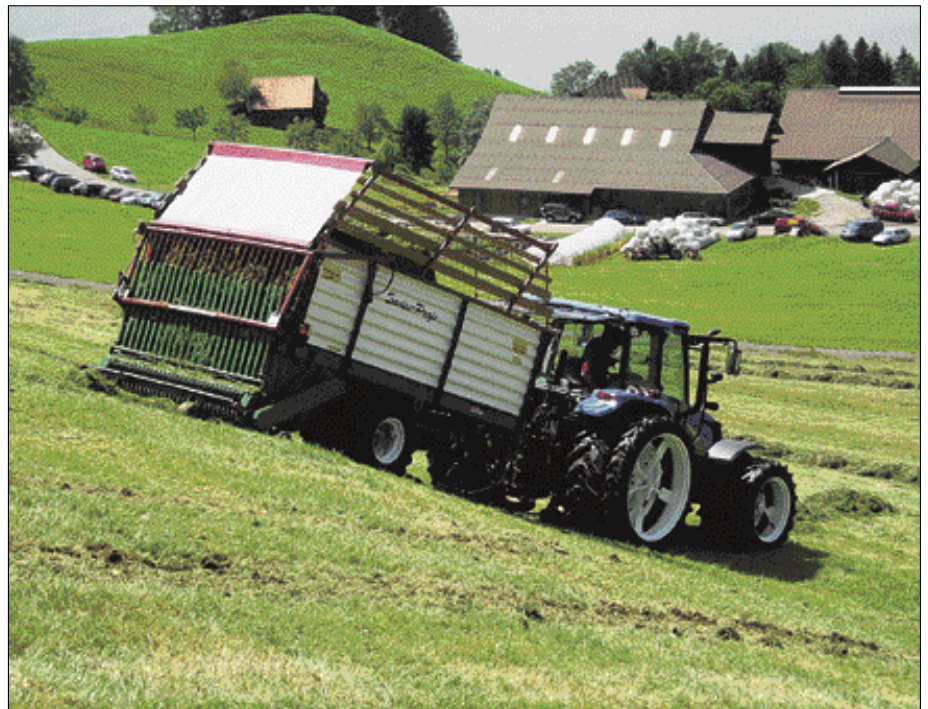
Auf die Sattelanhänger passen alle herkömmlichen Aufbauten der Transporter. Die Achslenkung erfolgt wahlweise spurtreu zum Traktor oder zum Pick-up.
